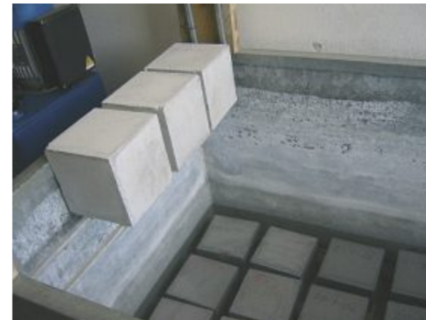
> Cubetti per prove di resistenza alla compressione
